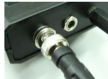
ช่อง BNC สำหรับต่อหัววัดความสั่นสะเทือน
